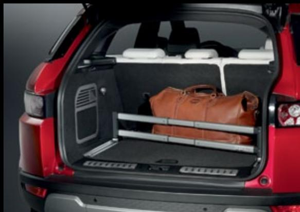
**Tapis en caoutchouc de recouvrement du compartiment à bagages**
