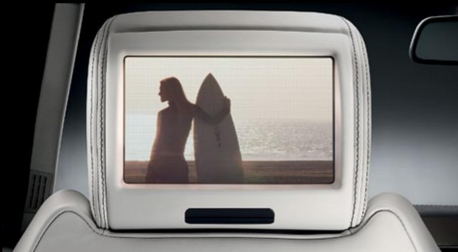
Le Range Rover Evoque dispose d'un système multimédia\* avec écrans pour passagers arrière permettant de lire des DVD en haute qualité et de diffuser l'image sur les écrans de huit pouces intégrés aux appuie-tête avant, ainsi que sur l'écran tactile à double vision du passager avant.
