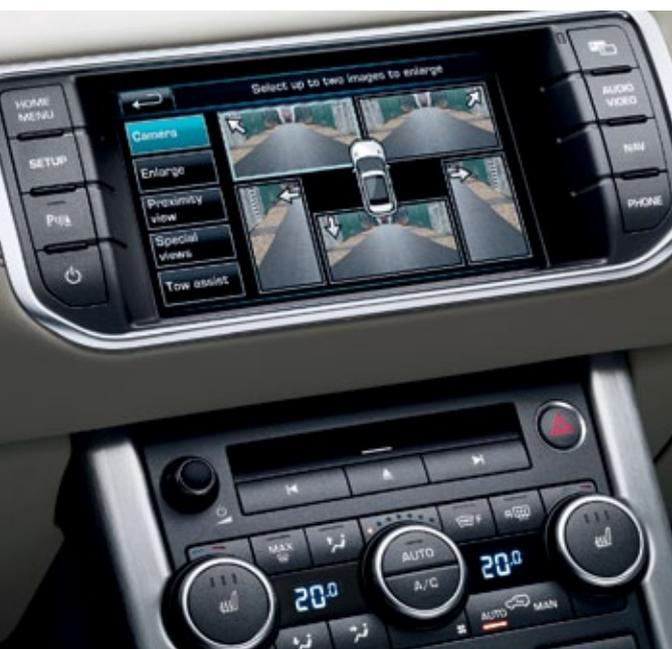
Le système de caméras panoramiques\* régit cinq caméras numériques discrètement disposées sur le véhicule afin d'en offrir une vue extérieure de presque 360° sur l'écran tactile de 8 pouces du tableau de bord. Cette technologie apporte des indications précieuses au conducteur, lors de manœuvres sur route comme en tout-terrain. Les cinq caméras numériques sont incorporées à la carrosserie du véhicule : deux à l'avant, une de chaque côté, et une à l'arrière.
