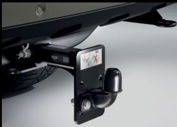
Barre d'attelage avec crochet réglable** VUB000720 Offre trois hauteurs de remorquage. La hauteur la plus basse est de 360 mm à partir du sol. Capacité de remorquage maximale de 3 500 kg. (Charge verticale de 150 kg).
