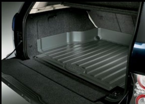
Bac de coffre rigide EBF000040 Avec revêtement antidérapant (non présenté). Accès facile aux points d'ancrage grâce aux rondelles amovibles. Non compatible avec la grille de séparation d'aire de chargement.
