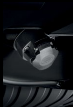
Branchements électriques 13 broches† VPLMT0007 Branchements électriques de norme européenne, capables d'alimenter les feux arrière des remorques ainsi que les équipements intérieurs. A partir de AM 2010.
