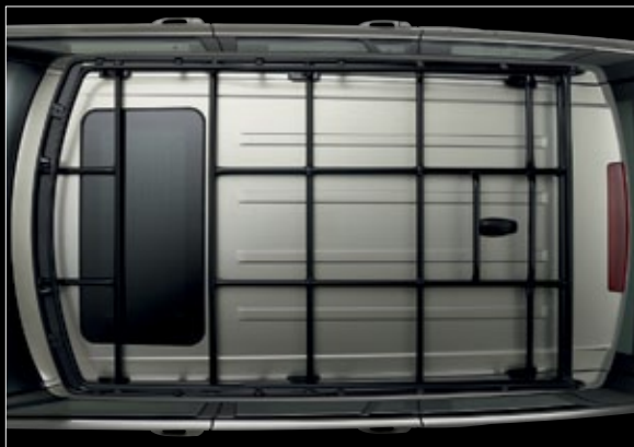
Galerie de toit Expedition CAB500070PMA Charge maximale : 81 kg. Hauteur du véhicule en cas d'installation : 1 988 mm.
