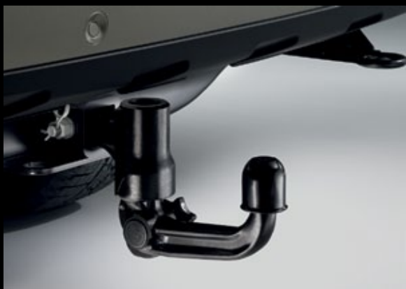
Barre d'attelage avec crochet amovible** VUB000730 Se démonte sans outil. Verrouillable. Capacité de remorquage maximale de 3 500 kg. (Charge verticale de 150 kg).
