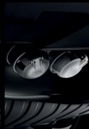
Branchements électriques '12N' / '12S'† VPLMT0006 Alimentent les feux arrière des remorques ainsi que les équipements intérieurs, le cas échéant. Fournis sous forme de kit combiné. A partir de AM 2010.
