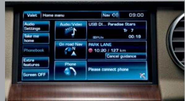
**ÉCRAN COULEUR TACTILE\*.** Pour activer intuitivement l'ensemble des dispositifs embarqués, comme les commandes de navigation, l'interface audio et multimédia, les caméras, les informations de conduite tout-terrain et les paramètres du véhicule.
