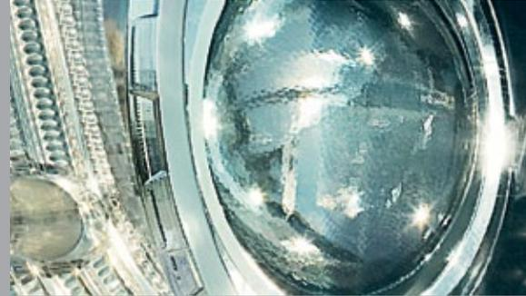
**PHARES À FAISCEAUX ORIENTABLES\***. Pour une conduite de nuit détendue, le système de phares à faisceaux orientables module l'intensité du faisceau projeté afin que celui-ci suive la courbe du virage.
