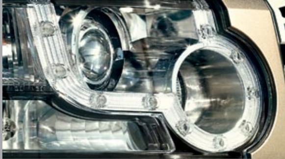
**ALLUMAGE AUTOMATIQUE DES PHARES AVEC SYSTÈME ANTI-ÉBLOUISSEMENT\***. Détecte les feux avant ou arrière des autres véhicules et passe automatiquement en feux de croisement jusqu'à ce que la source lumineuse de ces véhicules disparaisse. Cette technologie sait également distinguer les phares des véhicules d'autres sources lumineuses.
