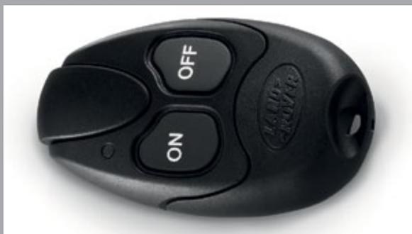
La programmation du système de préchauffage à distance\*, est disponible sur les motorisations diesel 3,0 litres. Il permet de préchauffer le moteur et d'acheminer la chaleur résiduelle dans l'habitacle, mais aussi d'y ventiler de l'air frais depuis l'extérieur, lorsque, par exemple, le véhicule est resté en plein soleil. Le système peut être programmé jusqu'à sept jours à l'avance depuis l'écran tactile. La télécommande est proposée en option.
