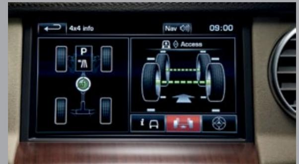
**SUSPENSION PNEUMATIQUE**. Suspension pneumatique à 4 roues indépendantes, de série sur tous les modèles de Discovery 4, avec hauteur de caisse variable et liaisons transversales électroniques qui apportent l'avantage d'une garde au sol constante, quelle que soit la répartition des charges à bord. Pour vous défaire des obstacles difficiles, la hauteur de caisse peut être rehaussée jusqu'à 125 mm ou abaissée de 50 mm pour faciliter l'accès et le chargement.
