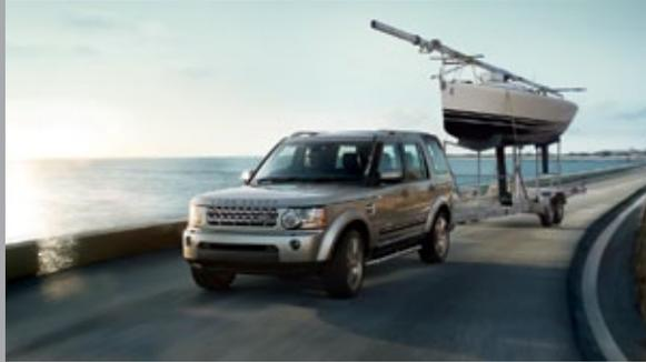
**CONTRÔLE DE STABILITÉ DE L'ATTELAGE (OU TSA).** De série sur tous les modèles, ce système sécurise les opérations de remorquage. Il détecte les oscillations de la remorque et applique une force de freinage appropriée pour corriger toute situation potentiellement dangereuse.
