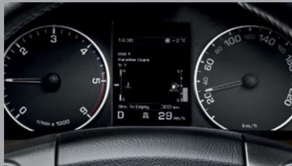
**TABLEAU DE BORD ÉLECTRONIQUE** avec écran TFT (Thin Film Transistor) de 5 pouces (12,7 cm) pour afficher les informations relatives au système audio, à votre annuaire personnel, à la navigation, ainsi que les pictogrammes pour vous guider, les principaux indicateurs de conduite et les messages d'alerte.
