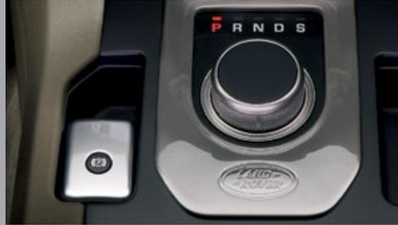
**FREIN DE PARKING ÉLECTRIQUE (OU EPB).** Un commutateur placé à côté du sélecteur rotatif de vitesses active ou désactive le frein de parking sur les roues arrière. En mode manuel, il vous suffit de tirer sur la poignée de frein pour enclencher le frein de parking ou de le relâcher pour libérer le véhicule. Lors de la mise en mouvement du véhicule, le frein de parking se désactive automatiquement.
